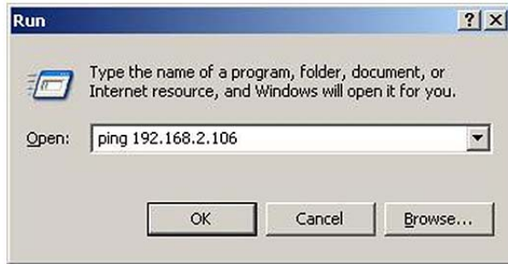
Fig. 23.-2 Ejecución de una prueba PING
