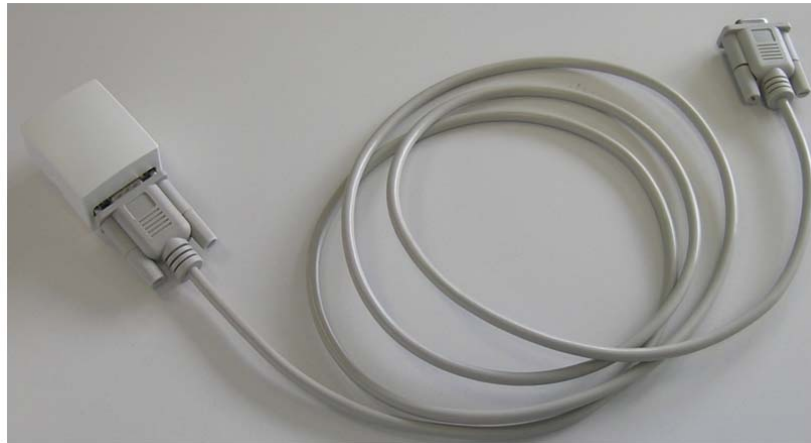
Fig. 15.1.-1 Cable en serie del REF 542plus con interfaz óptica infrarroja (IrDa)
