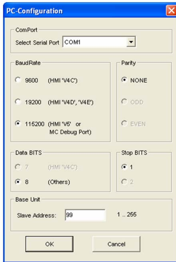
Fig. 15.3.1.-1 Configuración del parámetro de comunicación del puerto en serie
