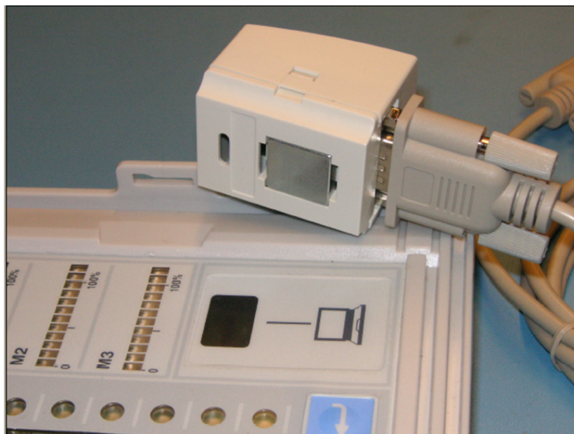
Fig. 15.1.-2 Interfaz en la HMI para el cable en serie con infrarrojo óptico (IrDa)
