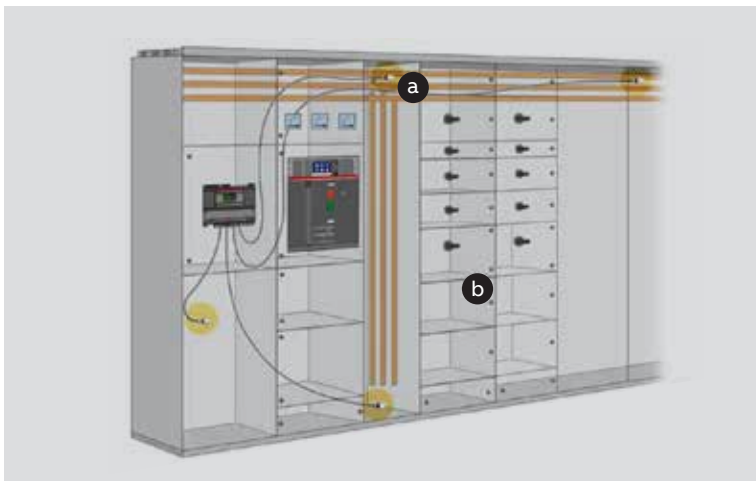
02 a Sistema de barras de distribución horizontales y verticales b Cubículo de interruptores
