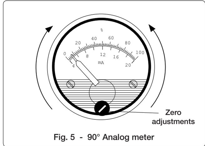
Fig. 5 - 90° Analog meter
