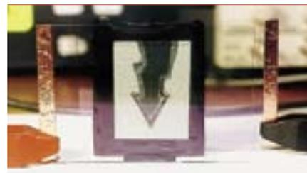
**2** Прототип пассивного индикатора напряжения (PVI)
