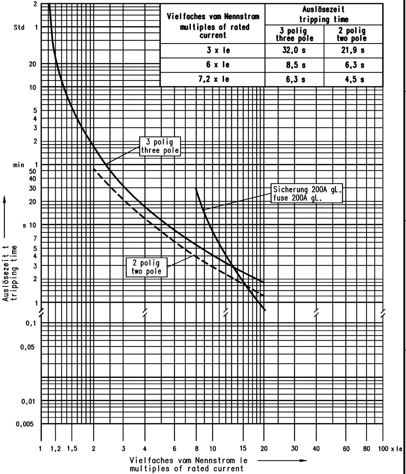
**Auslösekennlinie (aus kaltem Zustand)**
