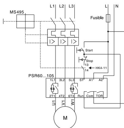
I) Con fusibles, contactor y sobrecarga
