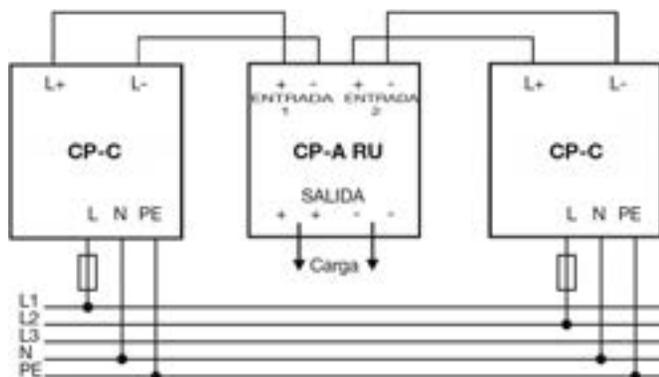
**Diagrama de conexión para incrementar capacidad**
