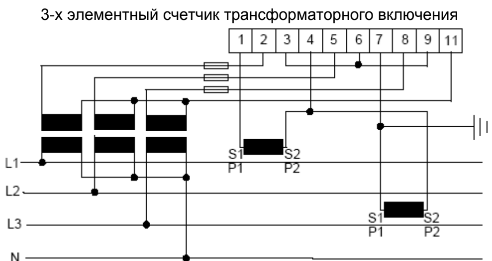
Рис. 5-13. Использование 3-х элементных счетчиков с 2 трансформаторами тока
