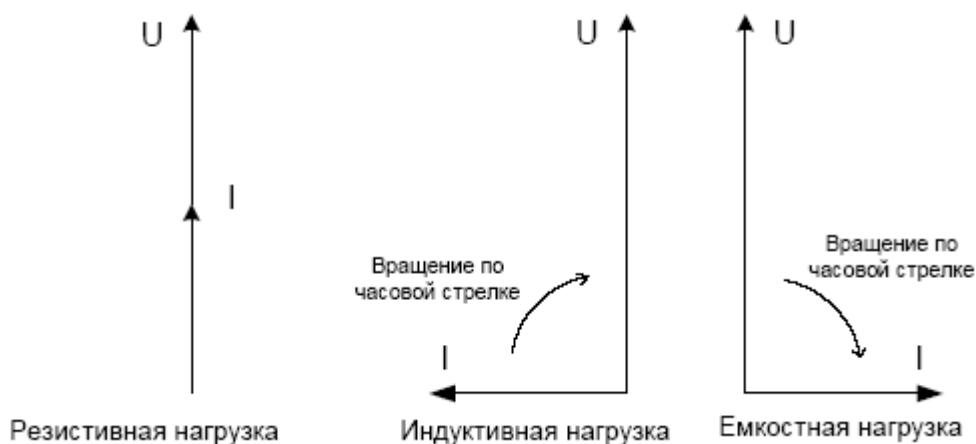
Рис. 5-1. Векторная диаграмма резистивной, индуктивной и емкостной нагрузки
