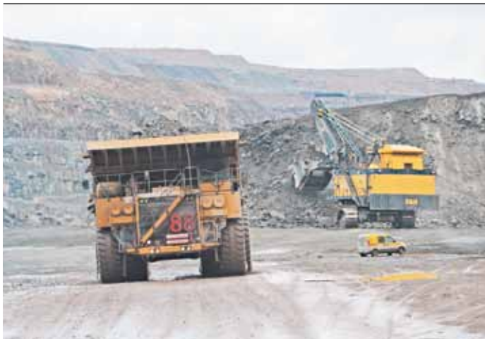
3 Массивные, 100-тонные грузовики с колесами 3,4 м используются для перевозки 200-тонных грузов в дробилку внутри карьера Аитик. Фото Петера Тубааса.
