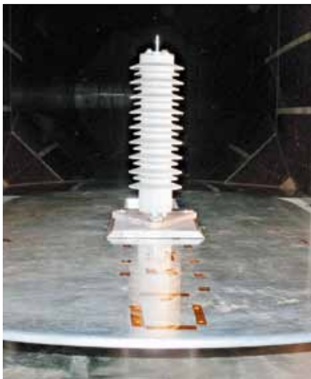
1 Установка для испытания разрядника типа POLIM-H 33 N в одной из аэродинамических труб немецкого аэрокосмического центра
