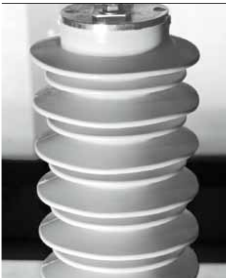
2 Силиконовый корпус разрядника типа POLIM-H 33 во время испытания воздушным потоком со скоростью 100 м/с (360км/ч)
