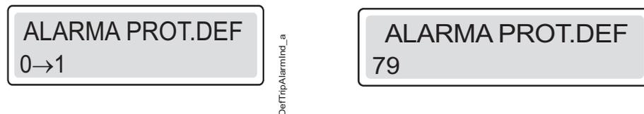
Fig. 3.3.2.1.-4 Indicación de alarma de disparo definido (modos IEC/ANSI)
