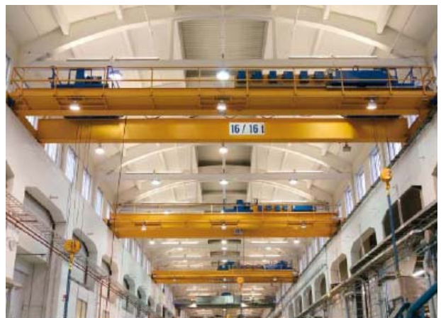
Movimientos de elevación, rodadura y desplazamiento largo optimizados en grúas industriales con el programa de control de ABB.
