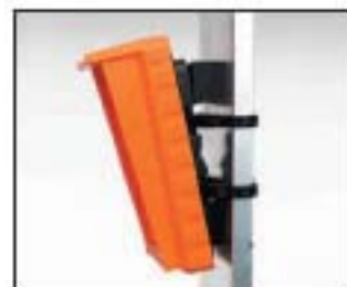
Fig. 9: VisiVolt™ acoplado a una barra pasante verticalmente en un sistema al exterior. Está fijado un espaciador debajo de la parte superior del VisiVolt™ para obtener el ángulo apropiado de instalación del indicador
