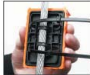
Fig. 6: Acoplando el VisiVolt™ en un conductor de sección circular de pequeño diámetro usando dos amarras de cable
