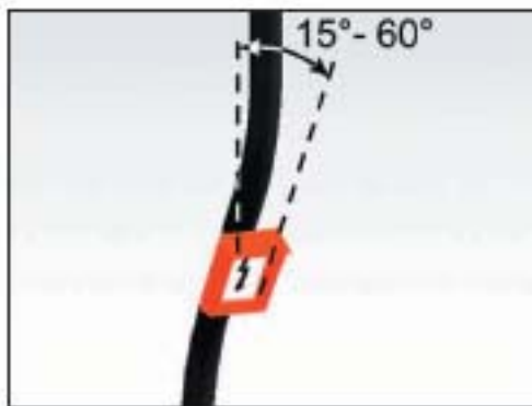
Fig. 11. Angulo de inclinación permitido del indicador VisiVolt™ instalado en una aplicación al exterior
