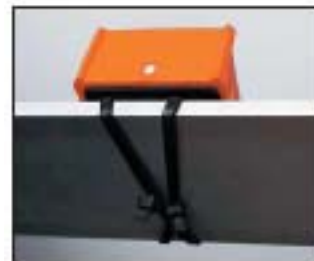
Fig. 8: Acoplando el VisiVolt™ en una barra horizontal usando dos amarras de cable
