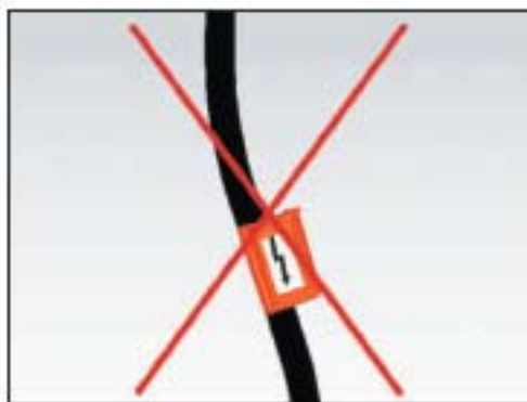
Fig. 12. Forma de instalación no permitida del VisiVolt™ para aplicación al exterior
