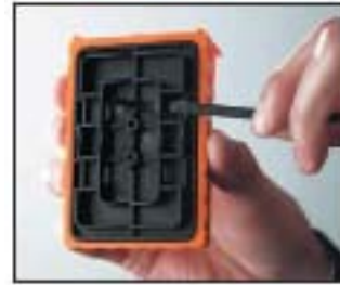
Fig. 4: Sujetando las amarras de cable en la parte posterior de la caja del indicador
