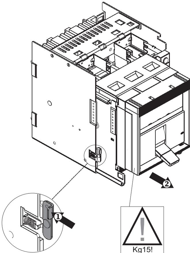
Per estrarre la parte mobile dalla parte fissa ripercorrere le operazioni descritte nelle fig. 12-16 in senso inverso. Al termine effettuare le due operazioni illustrate nella figura a lato.
