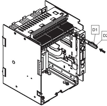
Esempio di cablaggio per parte fissa
