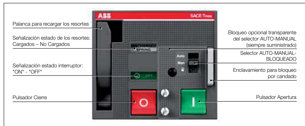
Mando a motor por acumulación de energía (MOE)
