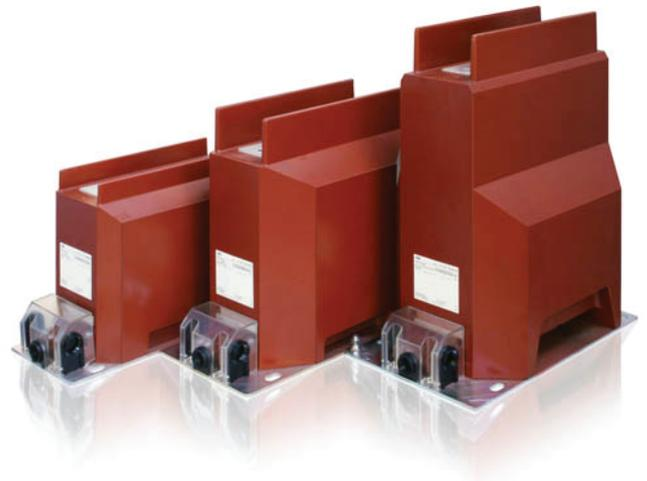
Конструкцией крышки предусмотрена возможность пломбирования доступа к выводам. Выводы имеют винты M5 для присоединения проводов и резьбовые отверстия для прямого при необходимости заземления одних из выводов вторичных обмоток (первый ряд вторичных выводов). Трансформатор может монтироваться в любом положении. Корпус трансформатора закрепляется с помощью 4-х болтов M12 через отверстия в металлическом основании. Заземляющий болт M8 находится на опорной плите трансформатора.
