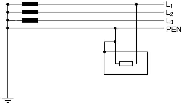
3. TN-C-S: las funciones de neutro y de protección están en parte combinadas en un solo conductor PEN y en parte separadas PE+N
