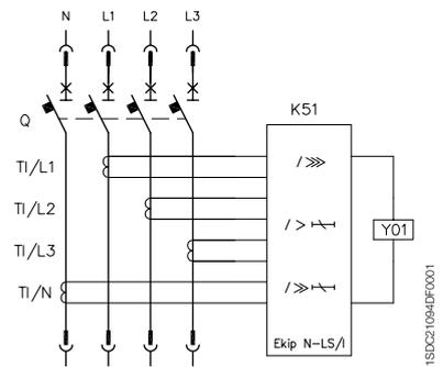
Interruptor tetrapolar con relé de microprocesador Ekip N-LS/I
