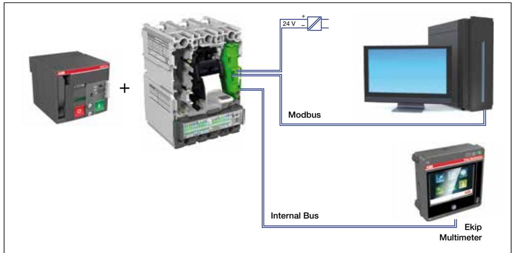
El accesorio Ekip Com, situado en la cavidad derecha del interruptor, se conecta con el relé Ekip LSI, Ekip LSIG o Ekip M-LRIU a través del conector suministrado con el Ekip Com y con el MOE-E a través del conector presente en la parte posterior del MOE-E. Del Ekip Com salen cuatro cables, dos de ellos necesarios para la alimentación auxiliar y dos para la conexión con el Modbus.
