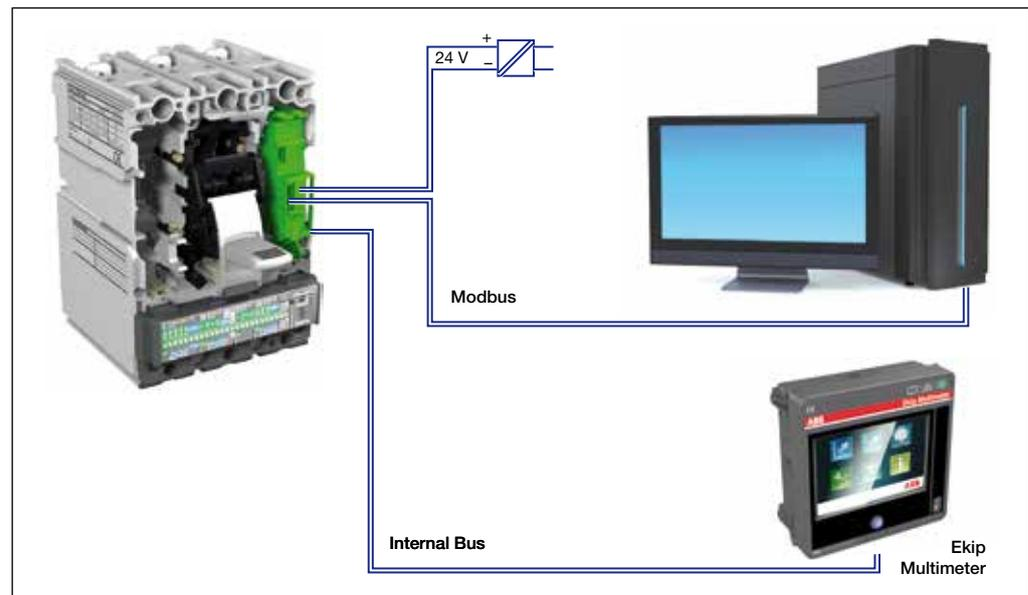
El accesorio Ekip Com, situado en la cavidad derecha del interruptor, se conecta con el relé Ekip LSI, Ekip LSIg, Ekip E-LSIG o Ekip M-LRIU a través del conector suministrado. Del Ekip Com salen seis cables, dos de ellos necesarios para alimentación auxiliar, dos para la conexión con el Modbus y otros dos para la conexión con el Modbus.
