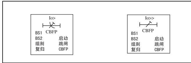
图 7.1.2.-1  $I_{o>}$  和  $I_{o>>}$  的功能模块符号**不带方向接地保护，低定值段， $I_{o>}$**
