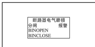
图 7.4.1.-1 CB wear 的功能模块符号
