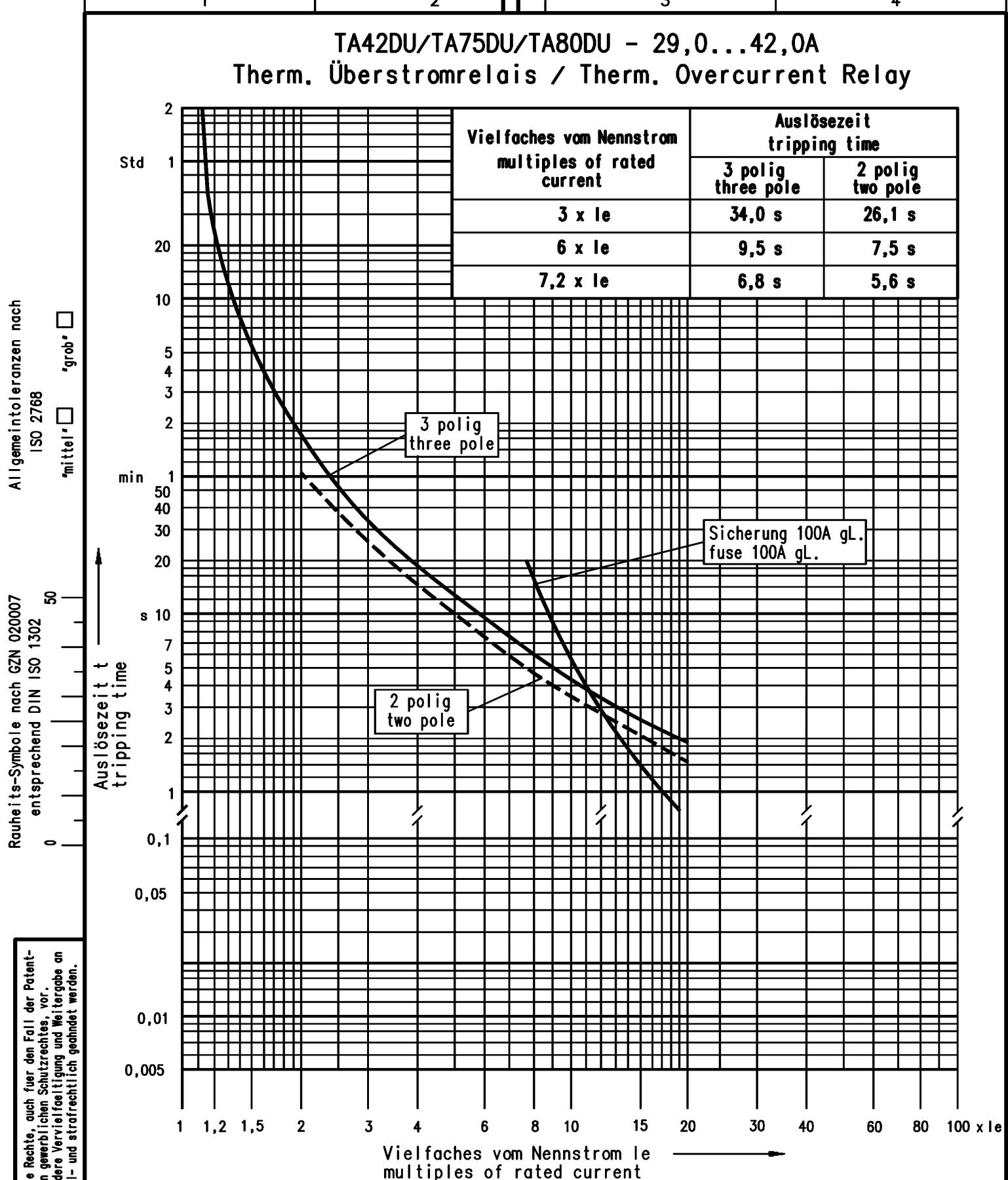
Auslösekennlinie (aus kaltem Zustand)
