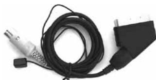
Il modulo comando TV viene attivato da un dispositivo di livello superiore (modulo testa letto/ elettronica di interfaccia a parete) e converte il comando ricevuto nel codice IR del televisore.
