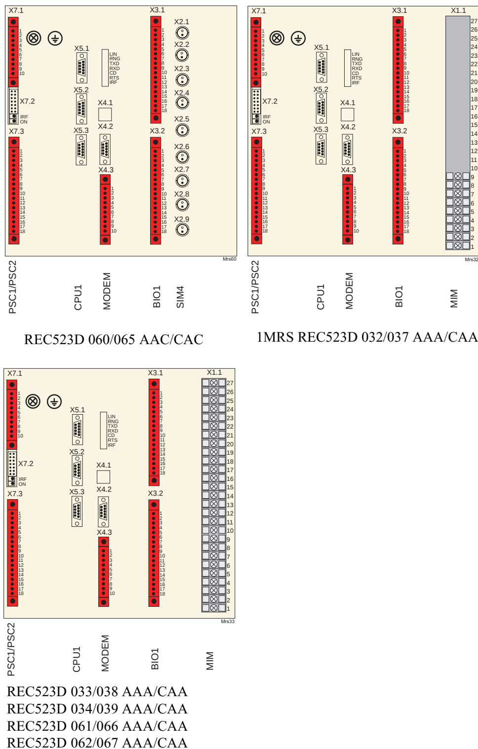
Fig. 6.1.-1 Différentes vues des bornes des unités REC 523.
