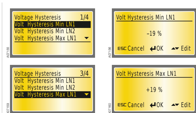
Рисунок 7.33 Гистерезис напряжения для линии LN1, заводская настройка: мин. -19%, макс. 19%
