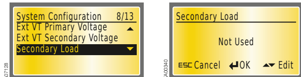
Рисунок 7.17 Вторичная нагрузка; по умолчанию Вторичная нагрузка не используется
