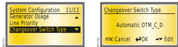
Рисунок 7.20 Тип реверсивного выключателя нагрузки; по умолчанию - автоматический OTM_C_D
