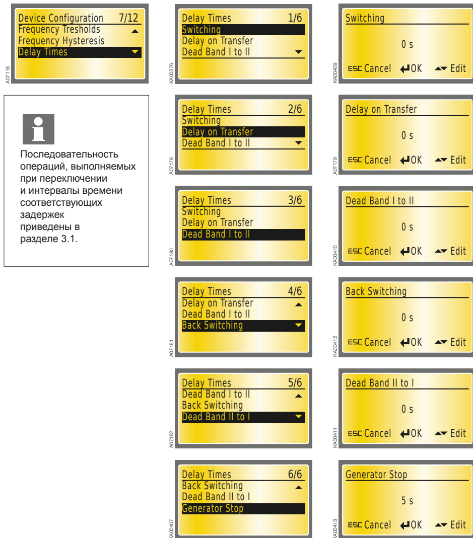
Рисунок 7.40 Переключение 0 с, задержка передачи 0 с, зона нечувствительности I - II 0 с, обратное переключение 0 с, зона нечувствительности II - I 0 с, отключение генератора 5 с
