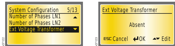
Рисунок 7.14 Внешний трансформатор напряжения; по умолчанию не используется
