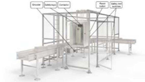
Kuva 7. Valvontalaitteet vastaanottavat signaaleja ja lähettävät ne taajuusmuuttajaan. Turvalaitteita ja kytkentöjä tarvitaan enemmän kuin integroitua taajuusmuuttajan toiminnallista turvallisuusratkaisua käytettäessä (katso kuva 8).
