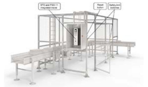
Kuva 8. Taajuusmuuttajaan integroitu turvalogiikka. Turvalaitteita ja kytkentöjä tarvitaan vähemmän kuin perinteistä turvallisuusratkaisua käytettäessä (katso kuva 7).
