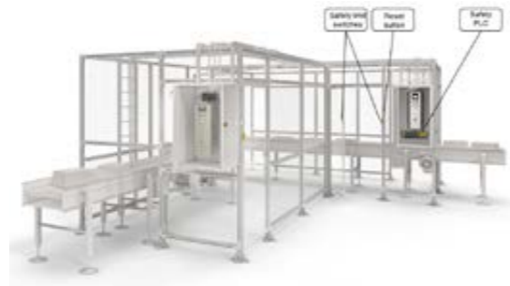
Kuva 9. Ohjelmoitavalla turvalogiikalla ohjattu turvallisuusjärjestelmä, jossa on sekä perinteisiä että taajuusmuuttajaan integroitua toimintoja.
