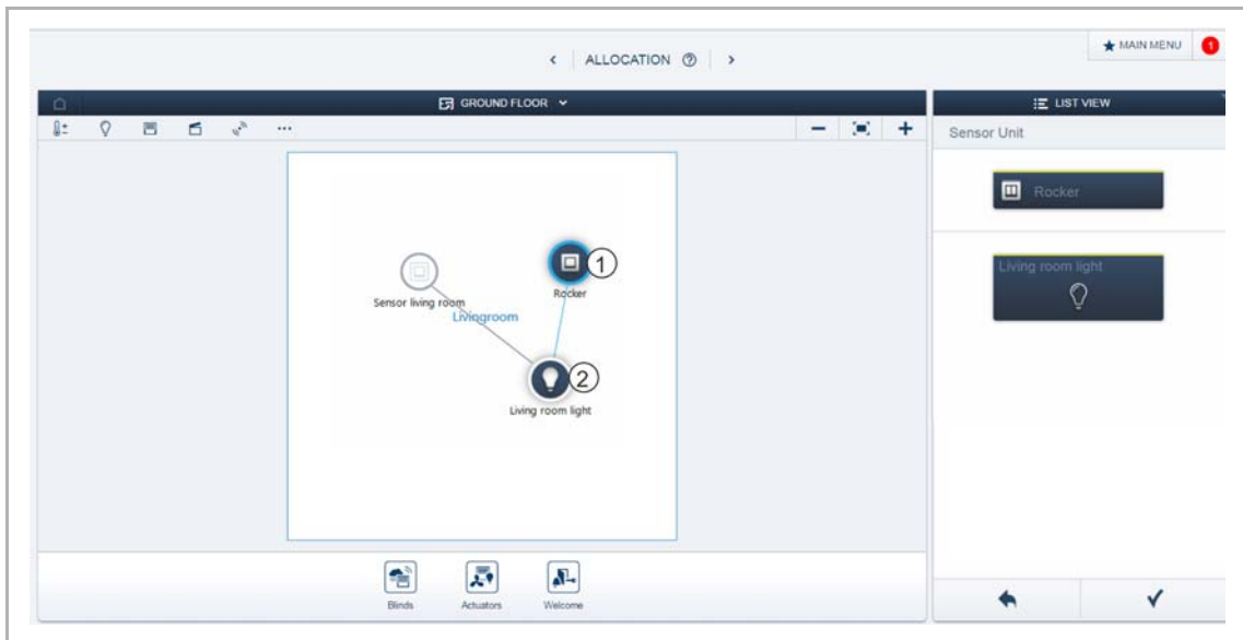
Fig. 22: Länka manöverdonet med ytterligare en sensor
