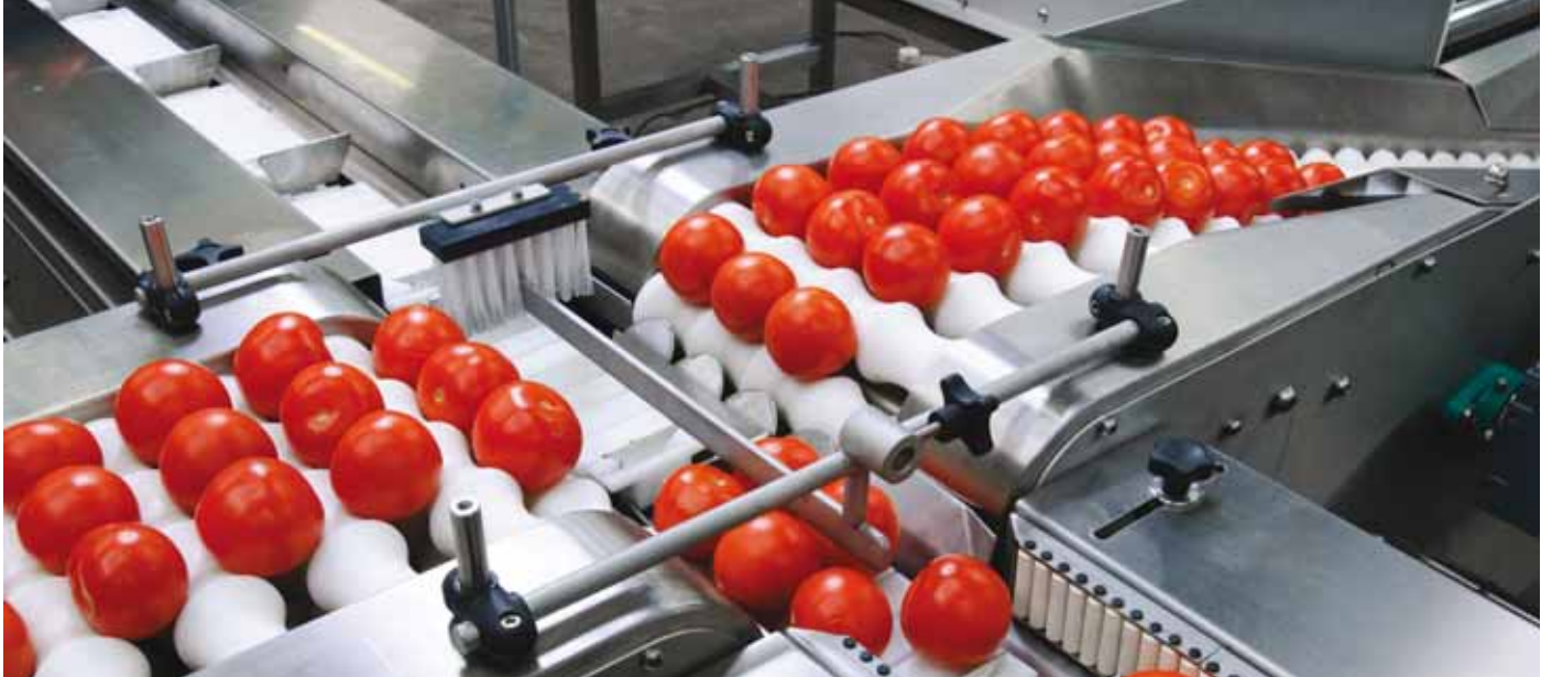
Los convertidores de frecuencia de alto rendimiento de ABB para maquinaria controlan la velocidad de los transportadores-manipuladores de tomates.
