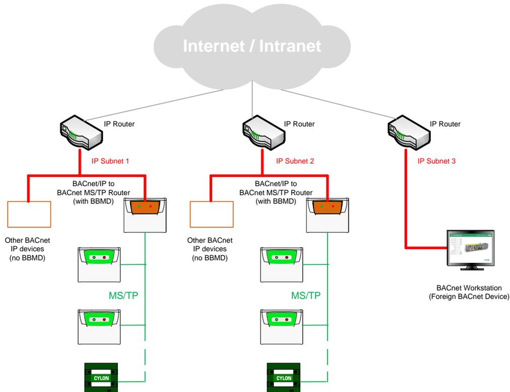
Das BBMD stellt fest, wenn in seinem IP-Subnetz eine Broadcast-Nachricht versendet wird, und erstellt dann eine „Peer-to-peer“-*Nachricht*, die über einen IP-Router versendet wird. Diese „Peer-to-peer“-*Nachricht* wird von anderen BBMDs in anderen IP-Subnetzen empfangen und in den angeschlossenen Subnetzen wieder als Broadcast verschickt.
