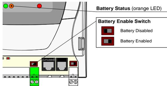
1. Deaktivieren Sie die Batterie mit dem Batterieschalter. (Die orangefarbene Status-LED leuchtet.)
