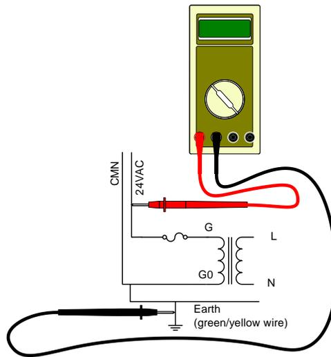
4. Geben Sie über den Netztransformator Spannung auf die CBM-Station.
