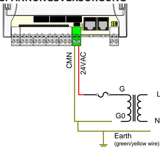
Die mit „24VAC“ bezeichnete Klemme wird an den anderen Ausgang der Sekundärseite des 24-V-Wechselspannungstransformators angeschlossen, im Regelfall über eine externe Sicherung. Die Scheinleistung in VA für die Berechnung der Kennwerte für diese externe Sicherung entnehmen Sie dem Datenblatt für die betreffende Station.
