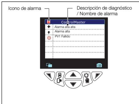
Fig. 5.2 *Vista de diagnóstico del ControlMaster* (se muestra el ControlMaster CM30)
