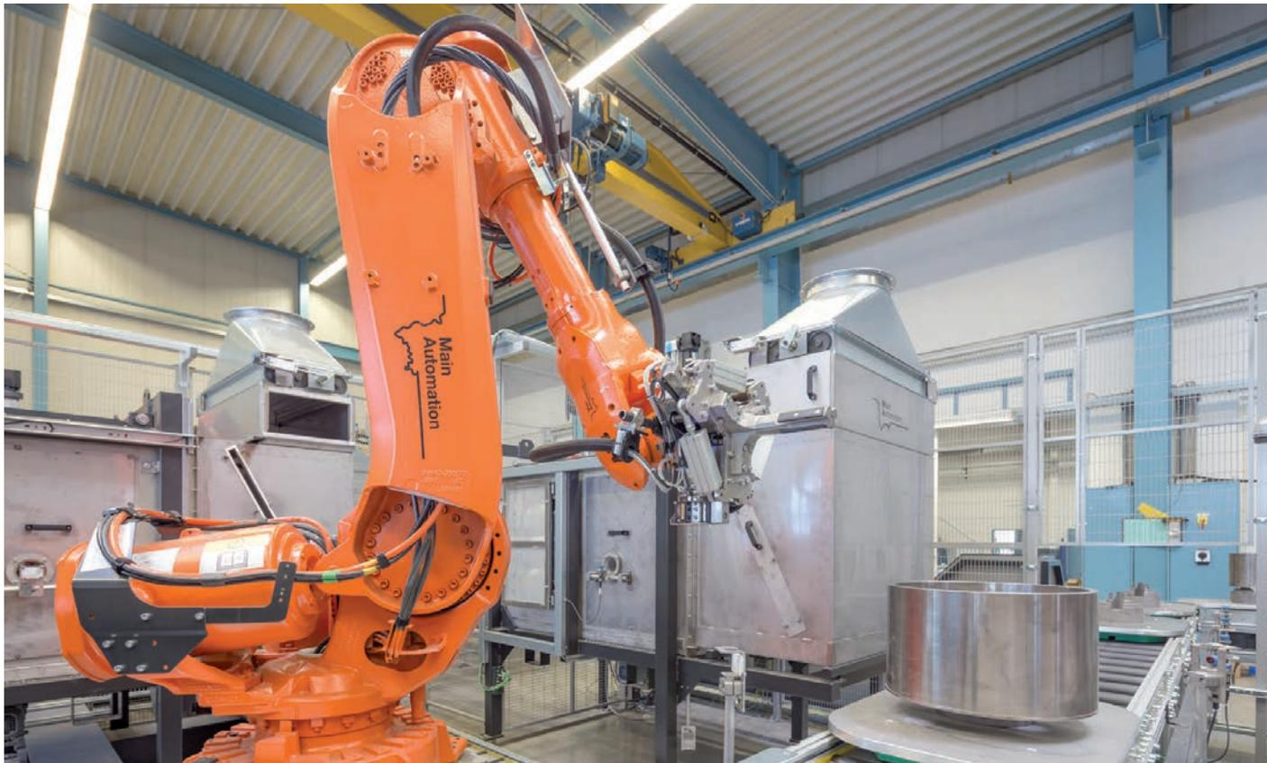
Rotoren für Aufzugsmotoren gibt es nicht von der Stange. Stattdessen müssen sie in vielfältigen spezifischen Ausstattungsvarianten hergestellt werden. Gut, wenn dann die Fertigungslinie die Varianten automatisch identifiziert und fehlerfrei bearbeitet. In einer von der Main-Automation GmbH für die ThyssenKrupp Aufzugswerke GmbH gebauten Anlage erledigen vier IRB 6640 und ein IRB 6650S von ABB diesen anspruchsvollen Job.
