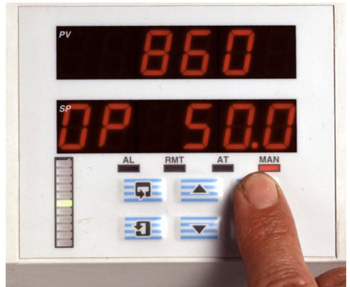
Die deutlich beschrifteten Membrantasten gewähren dem Bediener direkten Zugriff auf Einstellungen und Konfigurationen, somit erübrigt sich das Öffnen der Schreibertür. Eine Klartext-Bedienerführung in den Digitalanzeigen führt den Anwender durch die verschiedenen Menüs. Unbefugter Zugriff auf Konfigurationsänderungsmenüs wird durch einen Passwortschutz verhindert.
