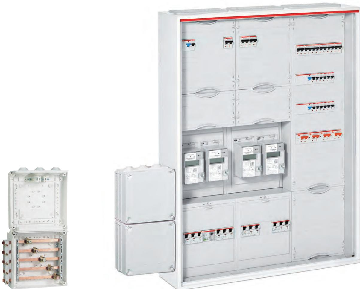
Einspeisegehäuse CZE230 mit Sammelschienensystem Cu 12 x 5 mm, 5-polig zur seitlichen Einspeisung rechts oder links am Zählerschrank. (Sammelschiennenanschlussklemmen Zubehör)
