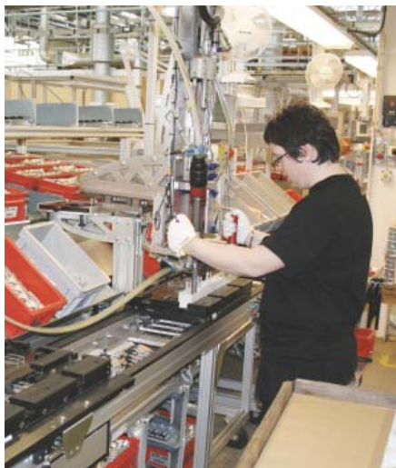
Montering av elkopplare och anslutningsdon.
