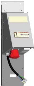
KSMUB 16/32 Tillfälligt uttag, 1x16 + 2x10 A alt 1x32 + 2x10 A med jordfelsbrytare och dvärgbrytare samt plats för kWh-mätare. Kortslutningshållfasthet 6 kA i kombination med utrustning max 63 A.
