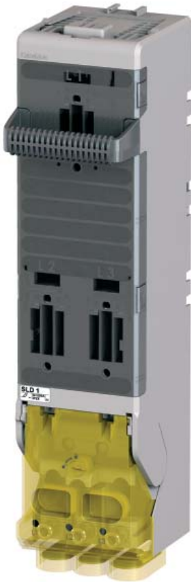
SLD 1 Säkringslastfrånskiljare. – AC-23B enligt SS-EN 60947-3 vid 400 V. – 10 moduler eller 120 mm bred. – Säkring NH 1 (max bredd 42 mm).
