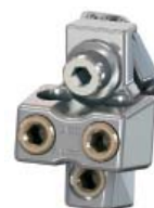
AD 350 Oisolerat anslutningsdon för anslutning av tre separata ledare. Används tillsammans med ej beröringsskyddade skenor.
