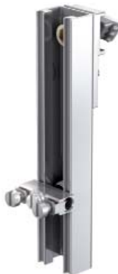
KSNSV 410 Vertikal PEN-skena, används vid utbyte av apparat i äldre kapslingar då utrymmet på PEN-skenan inte räcker till.
