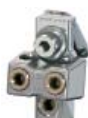
AD 350 Oisolerat anslutningsdon för anslutning av tre separata ledare, vardera max 50 mm 2 Al/Cu. Används tillsammans med ej beröringsskyddade skenor.
