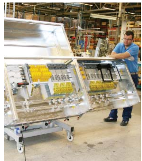
Montering av fördelningscentral enligt kundspecifika krav.
