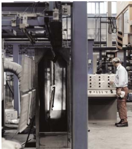
Pulverlackering av delar till fundament.
