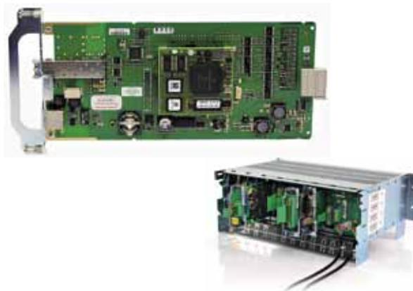
Des tests poussés ont été effectués sur la NSD570 G3LE dans un réseau comprenant un commutateur Ethernet de la gamme AFS d'ABB. Résultat : même en simulant un trafic par rafales de paquets de longueurs variables, sur certains segments de réseau surchargés, le temps de transmission reste inférieur à 4 ms pour avoisiner en moyenne 2,5 ms.
