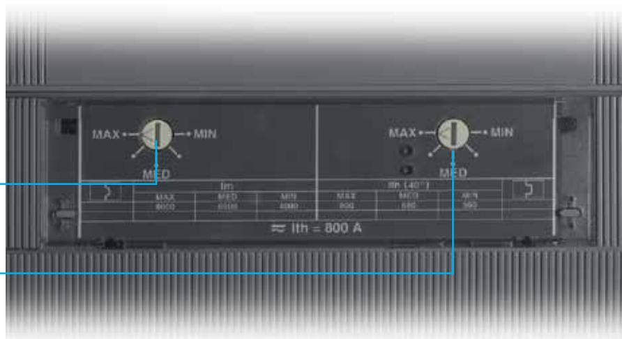
TMA = thermomagnetischer Auslöser mit einstellbarer thermischer Schwelle (I<sub>1</sub> = 0,7...1 x I<sub>n</sub>) und einstellbarer magnetischer Schwelle (I<sub>3</sub> = 5...10 x I<sub>n</sub>)
