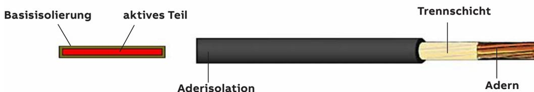
Bild 1: Basisisolierung am Beispiel einer Aderleitung mit Isolierung
