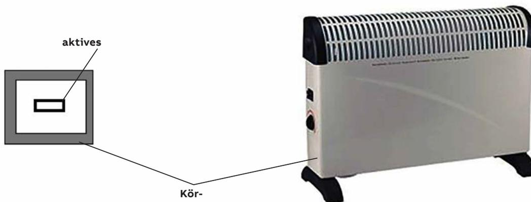
Bild 2: Basisisolierung am Beispiel eines SK I-Betriebsmittels mit einem Gehäuse (Abdeckung, Umhüllung)
