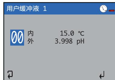
注释。按下 键可在点号、温度输入和 pH 输入之间循环。
