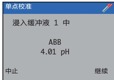
**5 将传感器浸入具有屏幕上所示值的缓冲液中。**
