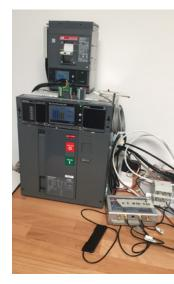
Um diese Vorteile kostengünstig und schnell unter Beweis zu stellen, hat ABB mit den SBB während der «Proof of Concept»-Phase in einer Laborumgebung gearbeitet. Im Labor wurde ein fehlerhafter Zustand an einem Leistungsschalter simuliert – in diesem Fall war es ein Temperaturanstieg. Anschliessend wurde ein Signal von der Hardware über die ABB Ability™ Cloud via API an den digitalen Zwilling der Anlage gesendet.
