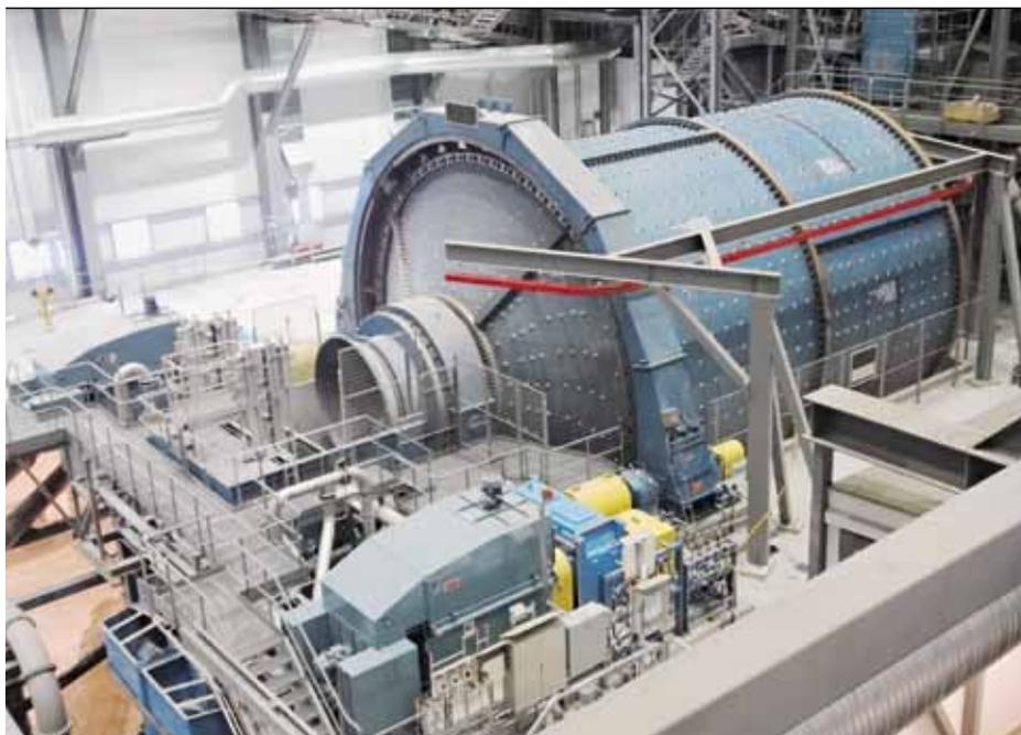
**D**ans les broyeurs à couronne, surtout ceux à 2 pignons, les moteurs peuvent considérablement amplifier les efforts mécaniques. Par conséquent, la commande des deux moteurs doit être rapide et précise afin d'éviter tout effort supplémentaire sur le système couronne/pignons.
