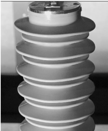
moments de flexion maximum spécifiés en continu des parafoudres correspondants. Les ailettes des enveloppes en caoutchouc de silicone n'ont pas oscillé à la vitesse maximale de 100 m/s, écartant tout risque de réduction importante des lignes de fuite, consécutive à la déformation de l'enveloppe du parafoudre → 2.
