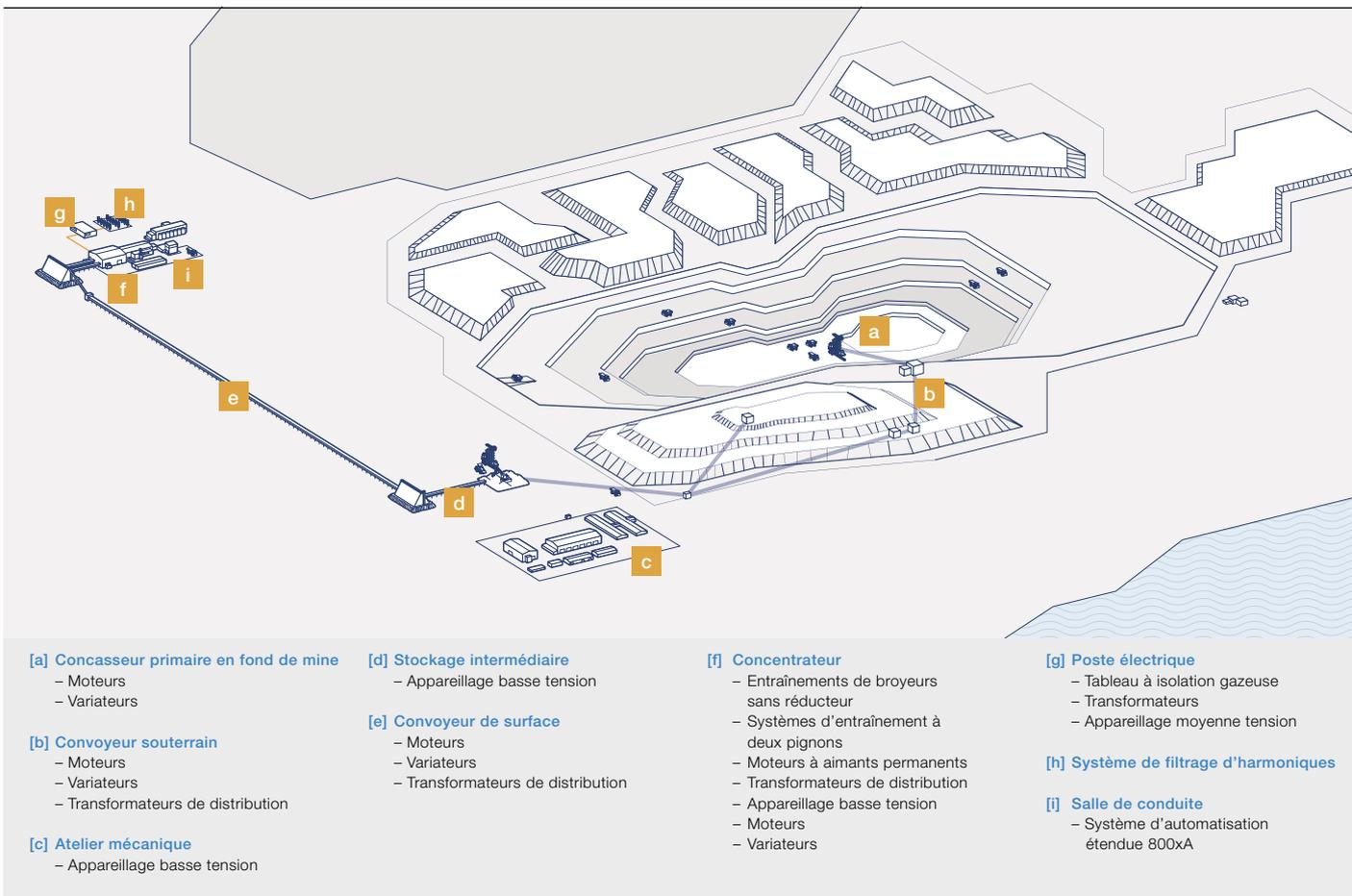
les plus hautes de la planète (4 600 m d'altitude), exploitée par le géant minier Chinalco. La même année, ABB recevait la commande d'un système sans réducteur de 28 MW pour entraîner le premier broyeur semi-autogène de 12,8 m de diamètre au monde. Le record de puissance revient aux deux entraînements de 22,5 MW qui pilotent les énormes broyeurs autogènes de 11,6 m de l'usine de concentration suédoise de Boliden. Aitik est aussi équipé des plus longs broyeurs au monde (13,7 m)!
