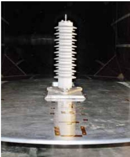
2 Enveloppe en silicone d'un parafoudre POLIM-H33 soumis à des vitesses de vent de 100 m/s (360 km/h).
