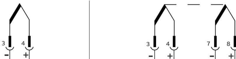
Abbildung 32: Thermoelement als Einfach- oder Doppel-Sensor
