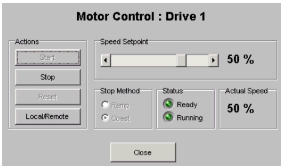
图 26 电机控制插件 – 变频器运行
