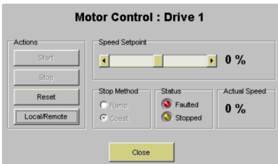
图 27 电机控制插件 – 变频器出现了故障
