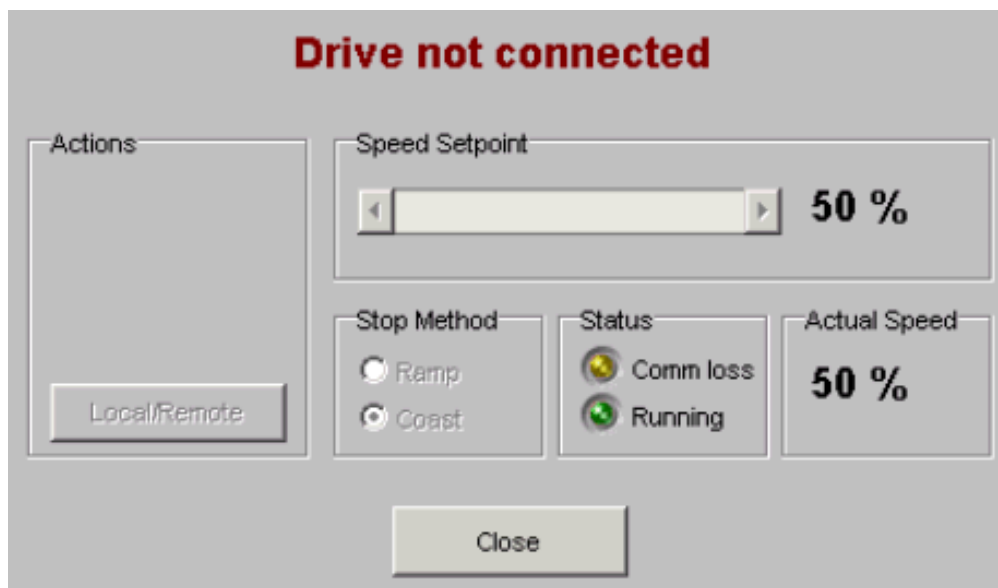
图 28 电机控制插件 – DDCS 通讯错误
