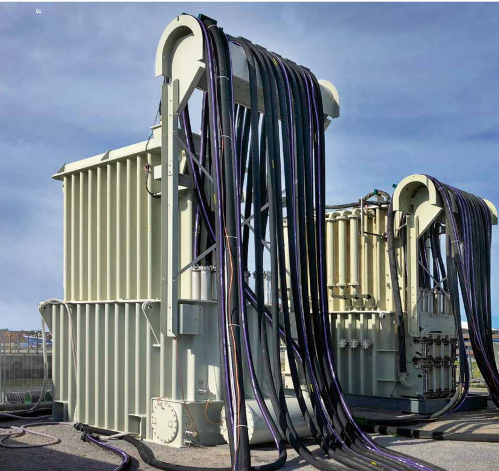
In Zusammenarbeit mit Industriepartnern hat ABB ein elektrisches Unterwasser-Versorgungssystem für die Öl- und Gasindustrie entwickelt, das seinesgleichen sucht. Das mit einem druckkompensierten Mittelspannungs-Frequenzumrichter ausgerüstete System steht kurz vor dem Abschluss des Qualifizierungsprozesses und ebnet den Weg für Unterwasseranlagen mit integrierten drehzahlgeregelten Antrieben für Pumpen und Kompressoren.
