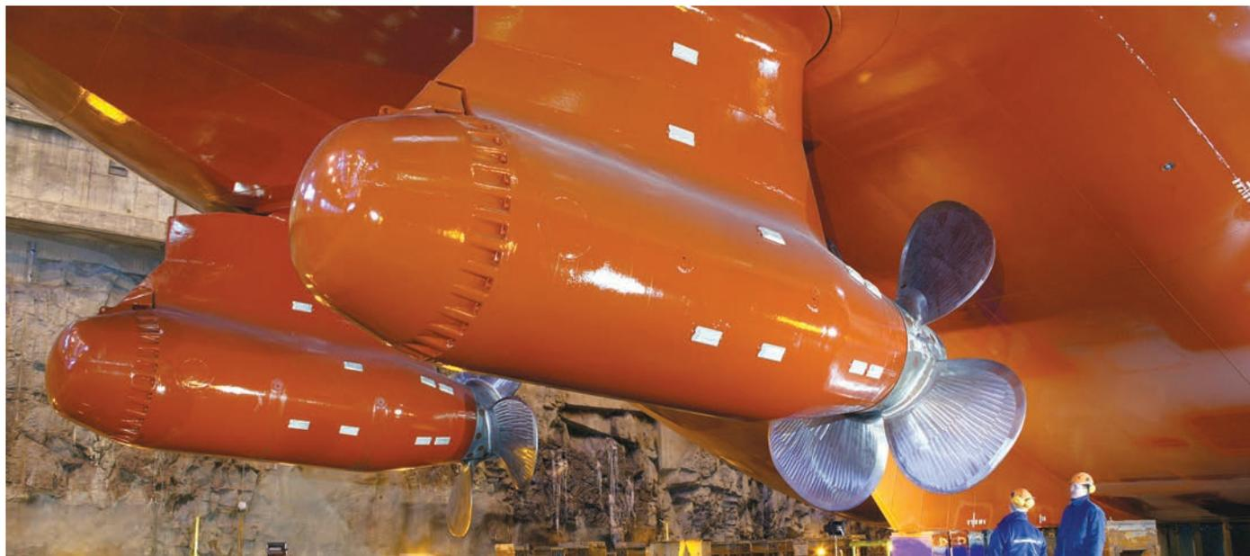
Двигательные установки «Azipod VI» в настоящее время поставляются с мощностью в диапазоне от 1,5 до 17 МВт.
