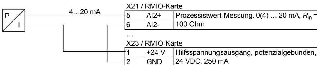
**Hinweis:** Der Sensor wird über seinen Stromausgang versorgt. Darum muss das Ausgangssignal im Bereich 4...20 mA liegen, nicht im Bereich 0...20 mA.
