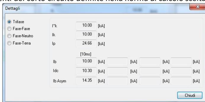
*Finestra Dettagli delle Correnti di corto circuito*
