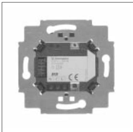
Der Dimmkaktor/-sensor ist für die Montage in einer 60 mm Unterputz-Dose nach DIN 49073 vorgesehen. Die Befestigung erfolgt wahlweise mit Schrauben über die Befestigungsbrücke oder schraubenlos mit einem Feder-Befestigungssystem.
