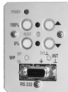
Рисунок 23: Сервисно-эксплуатационная панель (СЭП)
