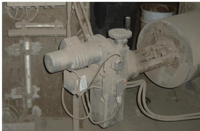
Рисунок 12: Линейный привод в горизонтальном монтажном положении
