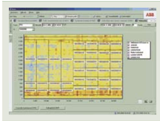
2 Анализ качества бумаги в исходном рулоне с помощью системы АББ CPM.
