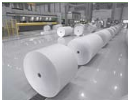
Рулоны бумаги, снятые с намоточного устройства бумагоделательной машины и готовые к упаковке
