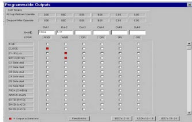
Figura 6-10. Lógica de Disparo de 51V
