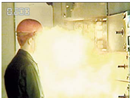
1a 没有保护情况下的电弧事故
