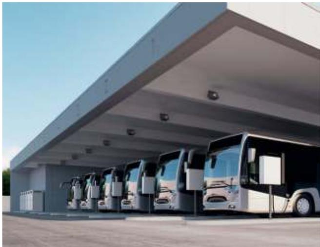
Sistema de carga nocturna de 150 kW con tres cajas de carga en depósito
