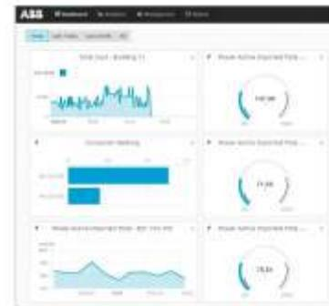
El nuevo ABB EQmatic Energy Analyzer es una solución compacta para monitorear, registrar, visualizar y analizar datos de energía y consumo de medidores de electricidad, gas, agua o calor a través de KNX, M-Bus o Modbus RTU. La IP disponible, se puede configurar individualmente según los requisitos respectivos y permite identificar el consumo de energía y optimizar los costos de la misma, de manera sostenible.
