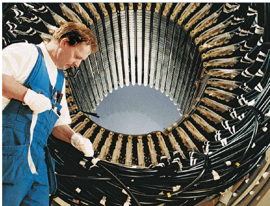
7 Type de moteur HT bobiné à câble utilisé pour alimenter la plate-forme Troll en mer du Nord.
