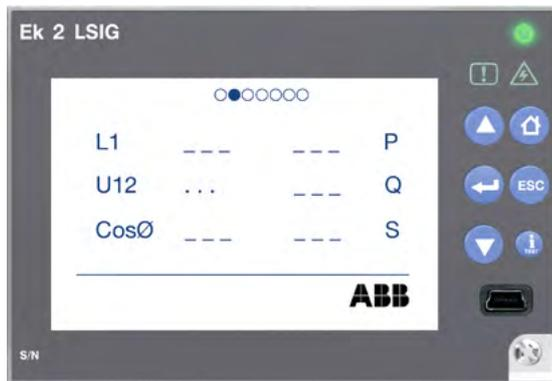
脱扣器的前面板上还有两个LED：一个预警LED（方形黄色LED）和一个报警LED（红色三角形LED）；为清楚地识别事件类型，LED始终随显示屏上的信息闪烁。只需按iTest按钮，即可查看此时所有活动报警的列表。
