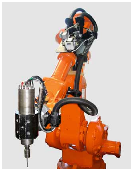
3 Robot équipé pour le contrôle d'effort
