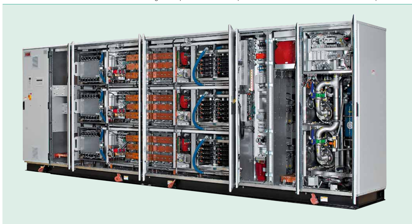
6 Le convertisseur ACS 5000 d'ABB utilise la technologie à cinq niveaux de tension qui fournit au moteur neuf niveaux de tension entre phases.
