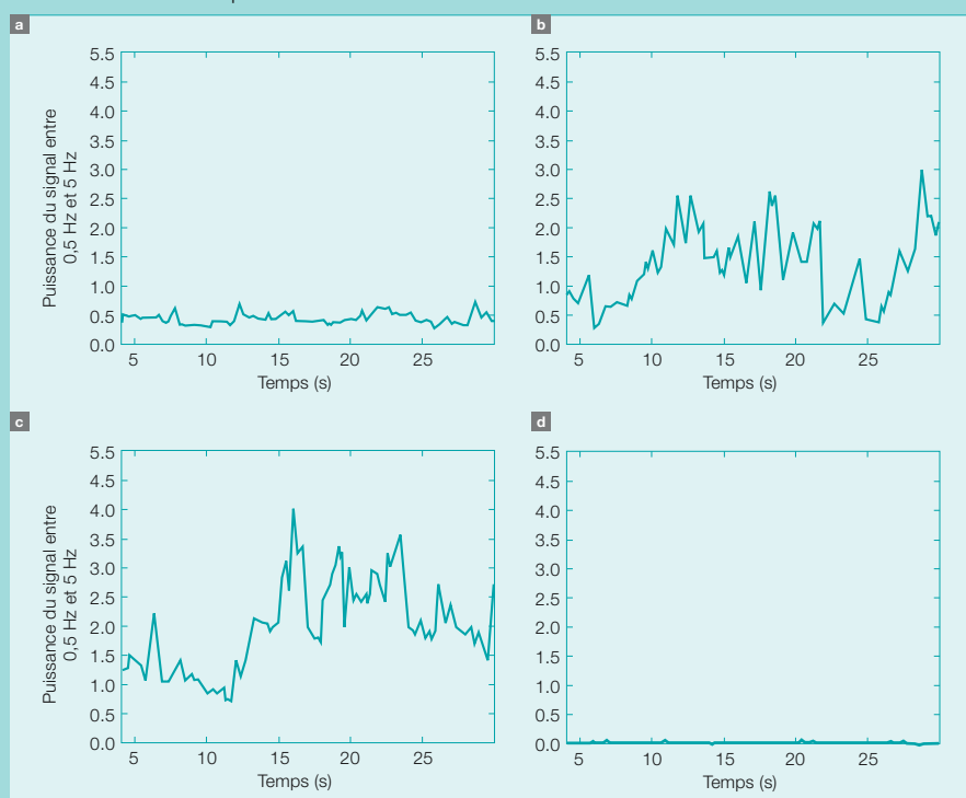
8 Puissance du signal sans prise d'impulsion obturée a , avec une des prises d'impulsion obturée b et c et les deux prises obturées d
