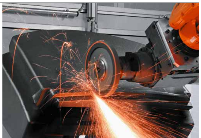
4 Opération de meulage avec décélération du robot en cas de bavure importante. La force mesurée est supérieure à la valeur de référence réglée, obligeant le robot à ralentir. Lorsque la force diminue, le robot réaccélère jusqu'à la vitesse programmée de 0,1 s.
